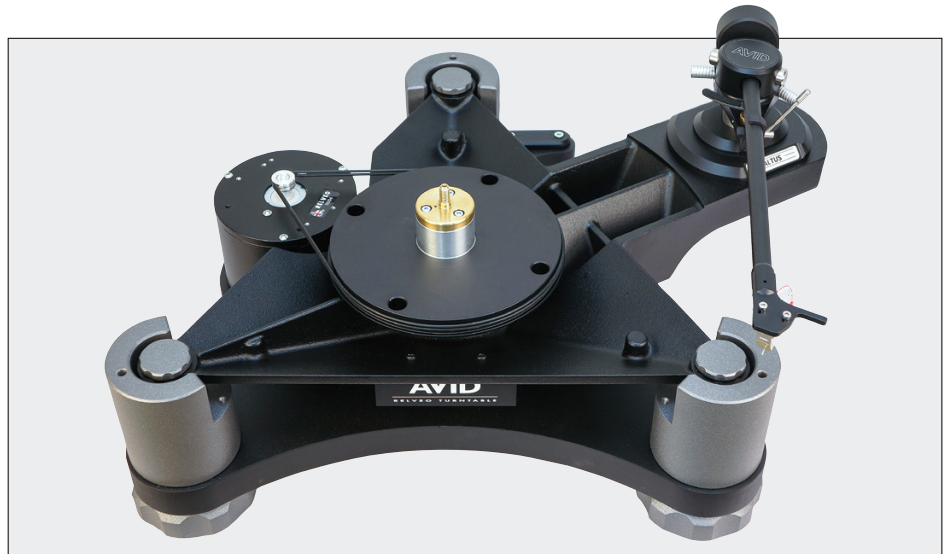
Der Plattenteller und der Tonarm sitzen unverrückbar gegeneinander auf einem dreieckigen, verstellten Metallträger, der an seinen Ecken an relativ steifen Elastomer-Dämpfern aufgehängt ist.
