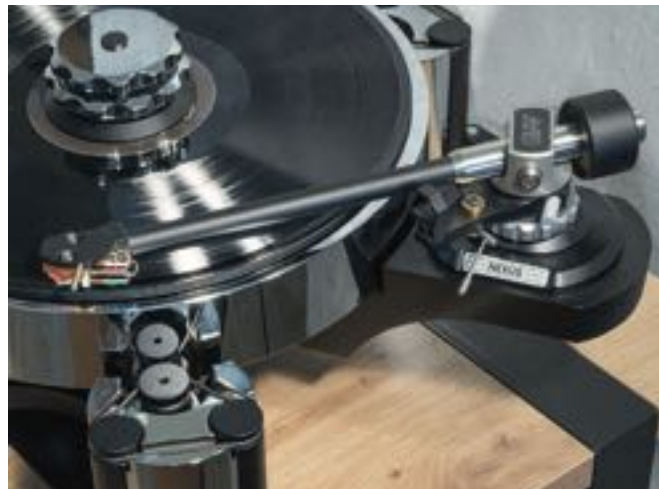
Il braccio è in titanio e alluminio e la regolazione del VTA avviene tramite la ghiera alla base e con una vite esagonale al lato del supporto.
