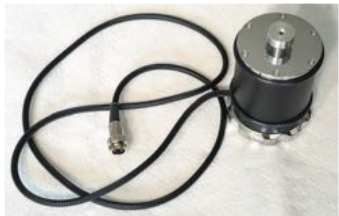
Il motore è dotato di una puleggia a doppia scanalatura che trascina una coppia di cinghie in gomma.
