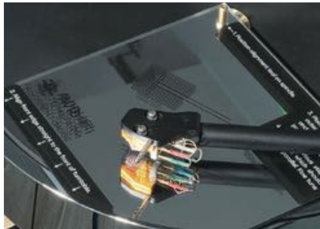
Per agevolare l'allineamento della testina viene fornito con il braccio uno specchio graduato realizzato appositamente.
