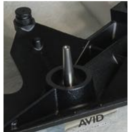
Sull'albero in acciaio è fissato il perno sul quale verrà posizionato il disco, mentre al suo interno si trova lo zaffiro sul quale poggia la sfera.
